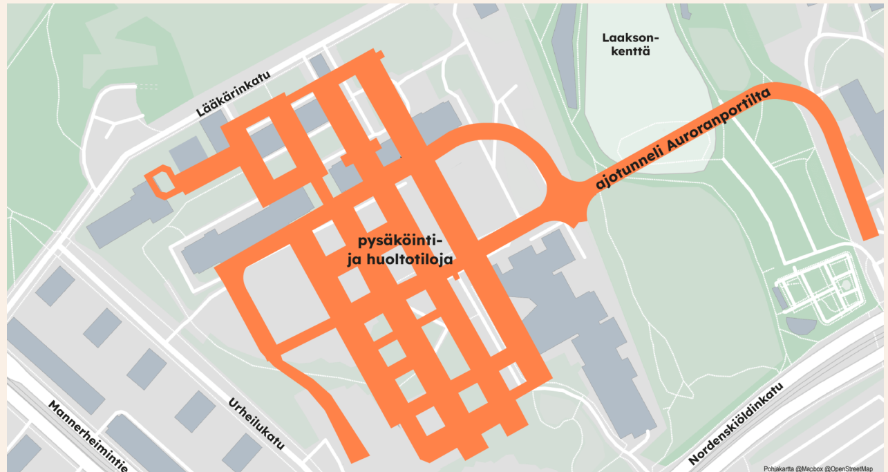
Kuva 34. Osaprojektin 2 maanalaiset työt. Kuvasta puuttuu Meilahti-Laakso-tunneli.
